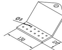
Pieza de extremidad perpendicular a la viga
