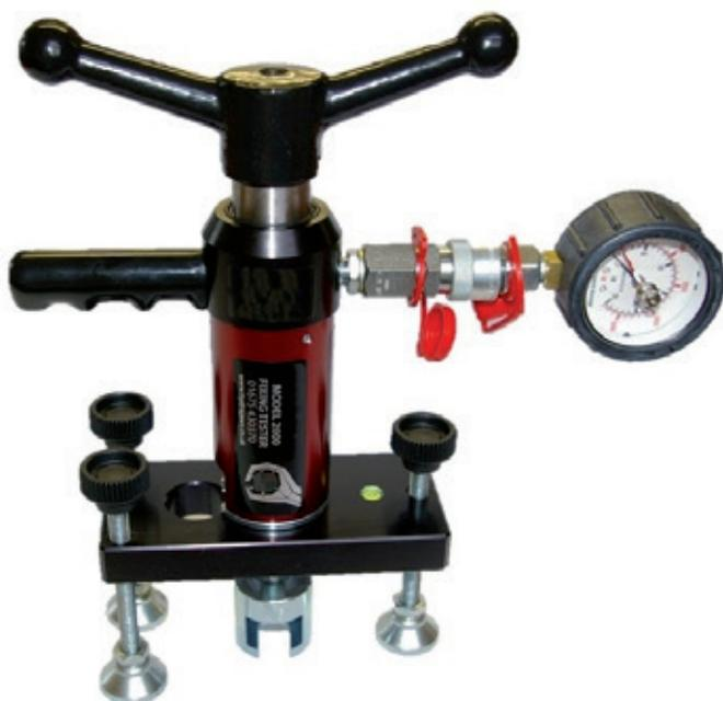
El extractómetro es un dispositivo portátil que permite realizar los test de extracción de los anclajes. Su función principal es la de confirmar en obra la resistencia de las fijaciones químicas sobre los materiales de construcción. Este dispositivo es indispensable para asegurar que un dispositivo de anclaje está instalado conforme a la norma EN 795 en vigor.
