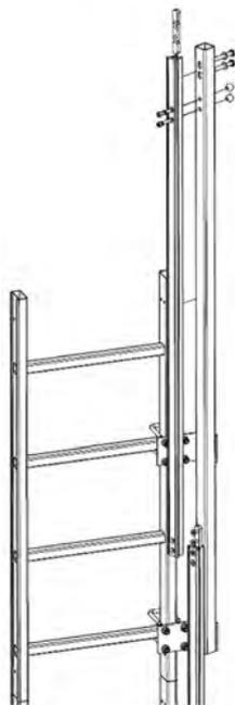
Extensión recta a fijar en el montante lateral, altura 1500
