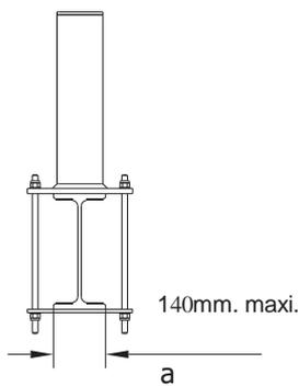
Fijación con 2 placas de embreado de acero galvanizado y 4 varillas roscadas M12. Postes disponibles altura 500mm. Fabricación específica para alturas superiores.
