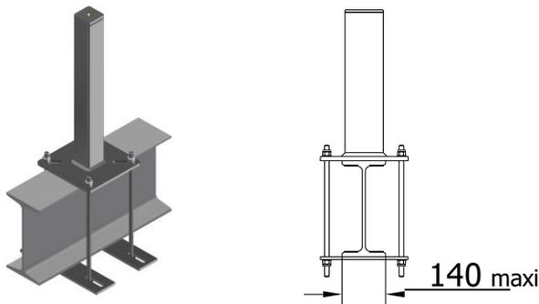
Fixation par deux brides en acier galvanisé et 4 tiges filetées M12
