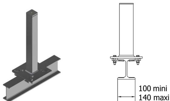
Fissaggio per 4 morsetti in acciaio galvanizzato e bulloneria M12
