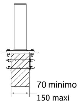
Fissaggio con due angolari bullonati sulla trave con bulloni M12
