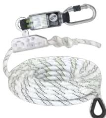
Funciona con cuerda trenzada de poliéster de 12 mm de diámetro, y se suministra montado de manera inseparable con su eslinga de anclaje con absorbedor de energía.
