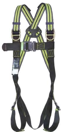
Dotado de 3 puntos de enganche con 3 conexiones automáticas. Cintas ajustables en perneras y hombros, diferenciadas con 2 colores distintos. Hebillas automáticas en cintas perneras y cinta esternal. Cinta subglútea con emplazamiento ideal para un mejor confort del usuario.
