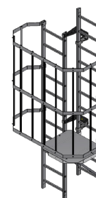
Cambio de tramo
