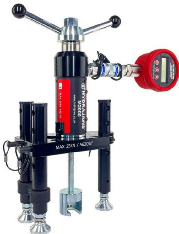
L'extractomètre est un dispositif portatif permettant de réaliser des tests d'extraction d'ancrage.
