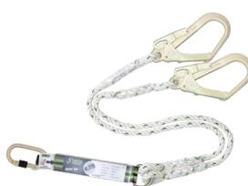
Longe en polyamide tressé de diam 12mm équipée d'une absorbeur d'énergie à sangle de 44mm de largeur.
