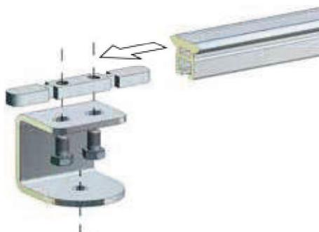
Fissaggio possibile su tutti i tipi di tetto con bullonatura del supporto del binario
