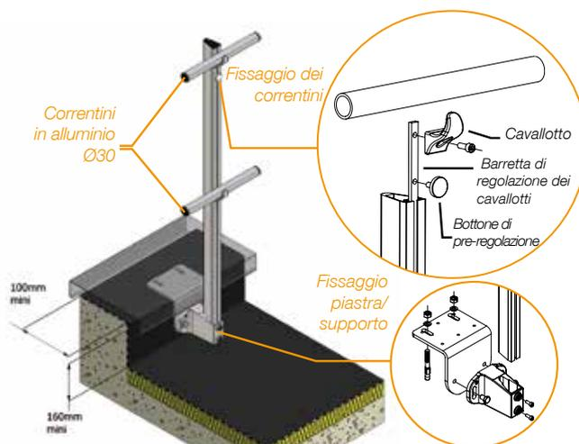
Struttura di appoggio: tetto terrazzato per interventi tecnici che presenta un muretto in calcestruzzo pieno, stagno con scossalina.
