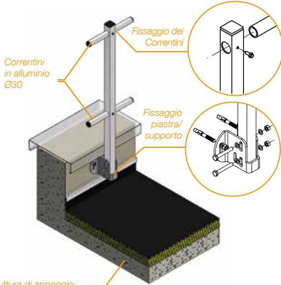
Struttura di appoggio: tetto terrazato per interventi tecnici che presenta un muretto in calcestruzzo pieno non stagno.
