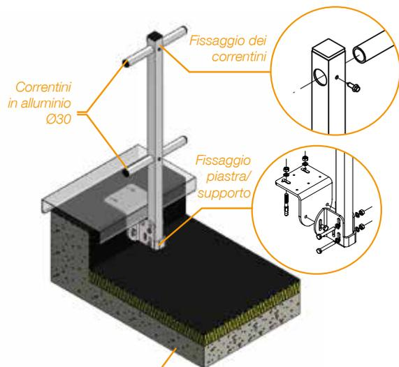
Struttura di appoggio: tetto terrazzato per interventi tecnici che presenta un muretto in calcestruzzo pieno, stagno con scossalina.
