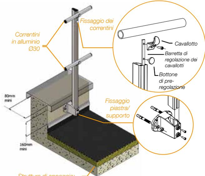
Struttura di appoggio: tetto terrazato per interventi tecnici che presenta un muretto in calcestruzzo pieno non stagno.
