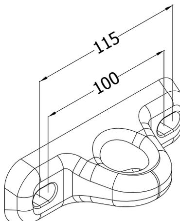
**L'ANCORAGGIO LASTRA** è un dispositivo di ancoraggio per tetti con lastra in acciaio. Non necessita di taglio o riparazione della copertura. L'ANCORAGGIO LASTRA è dotato di un dissipatore di energia ed è fornito con una lastra di ANCORAGGIO FISSO in ACCIAIO INOX.
