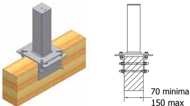
Fissaggio con due angolari bullonati sulla trave con bulloni M12
