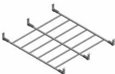
Griglia anticaduta in alluminio, da fissare sul bordo del lucernario. Dimensioni griglia min: 500 x 750 mm Dimensioni griglia max: 1000 x 2000 mm
