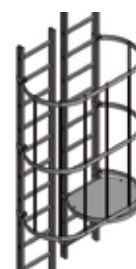
Pianerottolo con cambio di rampa
